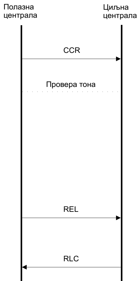
Слика 21: Успела провера континуитета на слободном колу
